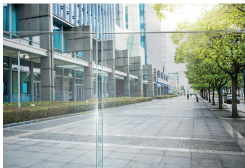
Low-E-Schicht mit Laser-Strukturierung (links) und ohne Laser-Strukturierung (rechts). Bild 69c00003
