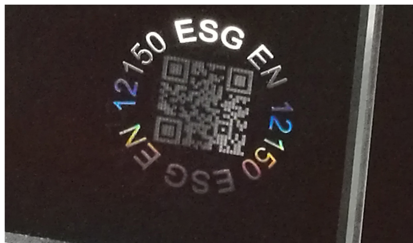
Hi-Res-ESG-Markierung auf der Glasoberfläche
