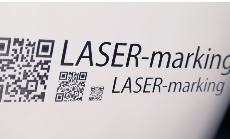
LASER-Kennzeichnung auf Glas
